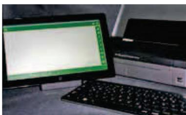
Der Messvorgang wird während der Erstellung einer digitalen Fotografie durchgeführt und bedient sich eines standardisierenden Dreiecks, welches als Referenzfläche für die umfangreichen Berechnungsprozesse in der Software dient.
